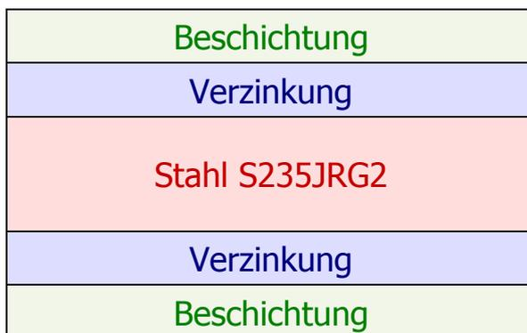
Optimalster Schutz mit der längsten Haltbarkeit. Die zusätzliche Beschichtung bietet den „doppelten“ Schutz. Die Farbe kann manuell (streichen, spritzen) oder industriell (Pulverbeschichtung) aufgetragen werden.
