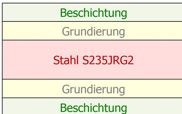
Darunter verstehen wir die Grundierung mit anschl. **Beschichtung**. Beide Bearbeitungsvorgänge werden meist manuell von dazu beauftragten Malerbetrieben vor Ort auf der Baustelle aufgetragen.
