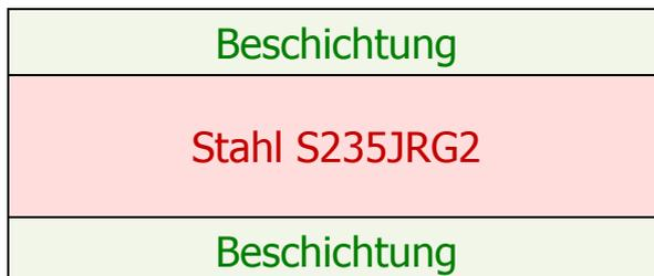
Die Pulverbeschichtung erreicht den höchsten Glanzgrad und ist verschleißfest.
